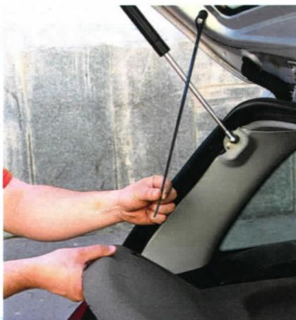
▲ Перетерлась и оборвалась одна из «подтяжек» задней полки. Через месяц за ней последовала другая.
