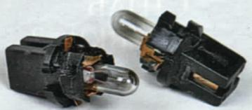
► Лампочки щитка приборов на протяжении пробега перегорали последовательно, и к 50 000 км их число выросло до четырех. Поменяли «котлом», причем в сборе с патронами, так как лампы в них впаяны.
