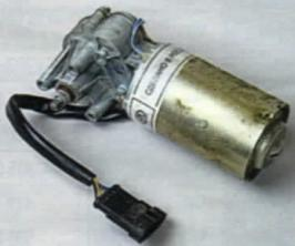
► Электромотор дворника отправили на помойку – он не обеспечивал необходимой скорости. Вдобавок из-за поломки одного из контактов перестал исправно работать и прерывистый режим: как только отпустишь рычаг стеклоочистителей, они, не отработав полный цикл, останавливались. Кстати, мотор продают только в сборе с трапецией.
