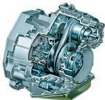
Управляют этой коробкой только гидравлические устройства. С одной стороны, стали не нужны сложные электронные компоненты. С другой – перенастроить характеристики «коробки» очень сложно: придется залезать внутрь, изменять настройки золотников, сечение масляных каналов и т. п.
