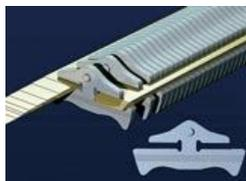
Основной элемент вариатора – гибкий металлический ремень, который передает крутящий момент с одного шкива на другой, контактируя с ними своими боковыми поверхностями. Примечательно, что ведущая ветвь ремня – толкающая. Каждый шкив состоит из двух половинок – усеченных конусов. Половинки одного шкива подпружинены, второго – передвигаются по оси с помощью гидропривода, играющего роль центробежного регулятора. Тем самым плавно изменяется передаточное отношение.
