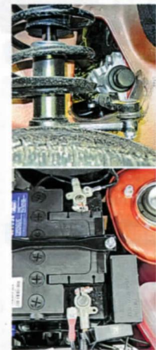
↑ Попробовали «протянуть» новую «Ладу». Вмешательства потребовали крепление рулевого механизма и провод на батарее.
