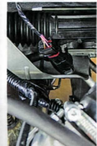
↑ Термоизолентой на АВТОВАЗе не пользуются – висящий в воздухе жгут проводов обмотан обычной ПВХ.
