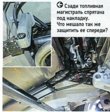
Сзади топливная магистраль спрятана под накладку. Что мешало так же защитить ее спереди?
