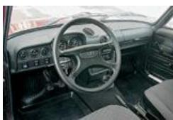
Хорошие «печки», жаркие! Только какая схема воздухоподачи хуже – два поворотных дефлектора у ВАЗ-2106 или чуть более разветвленная система ВАЗ-21053? Одну без определенной сноровки непросто отрегулировать, а другая оказалась слишком сложна в изготовлении – нормально состыковать на нашей «пятерке» трубы с дефлекторами в Тольятти не смогли. Сдается, это не единственный случай. Загадочно повел себя вентилятор отопителя на «шестерке», заработавший лишь при подъезде к редакции.
