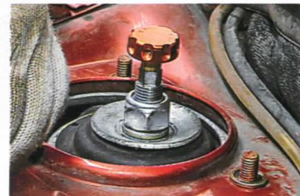
❸ Регулировка передних и задних амортизаторов AST 4100 с помощью шайб на штоке требует вдумчивой работы на автодроме.
