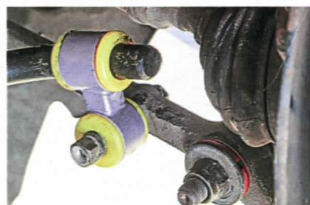
❹ После тестов трех комплектов тормозов и пяти комплектов подвесок резинометаллические шарниры устали – их заменили полиуретановыми SS20.
