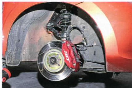
❷ После каждой замены мы выставляли углы установки колес с максимальным отрицательным развалом: на сильно заниженных стойках DAMP и AST удалось достичь развала -2,5°.
