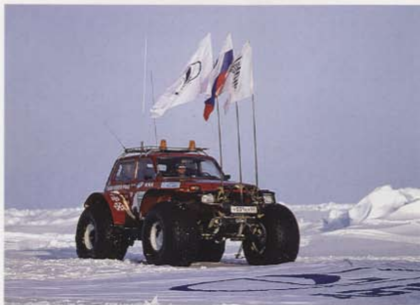
Экспедиция на Северный полюс. Болотоход «Марш» на базе внедорожника «Нива» преодолел в условиях бездорожья более 300 км
