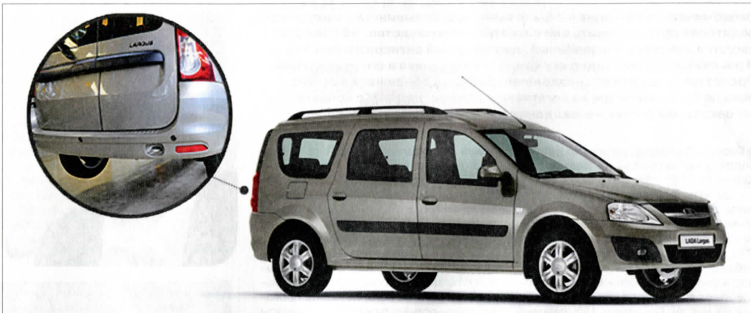
На задний бампер LADA Largus и LADA Largus Cross устанавливаются три ультразвуковых датчика парковочного радара
