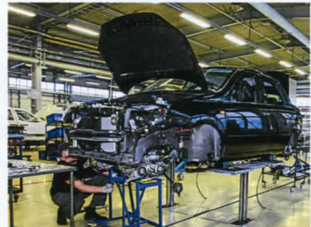
◀ Так называемая «свадьба». Кузов, уже обросший на конвейере оснащением, перегружают на подъемник, подкатывают к нему тележку с силовым агрегатом – и опускают вниз.
