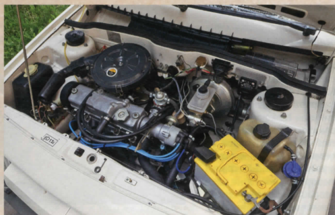
Поперечное расположение двигателя и трансмиссии, зубчатый привод распредвала, бесконтактная система зажигания — все это было инновациями в СССР середины 80-х
