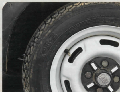
Бескамерные радиальные шины EX-85 165/70 R13, позже переименованные в Бл-85 после судебных разбирательств с маркой Michelin, которая имела единоличное право на использование индекса «Х» в обозначении моделей покрышек. Для удешевления изменений индекса в рельефе «EX» на боковине шин были найдены буквы, требующие незначительных изменений, — Бл, Белоцерковский шинный завод
