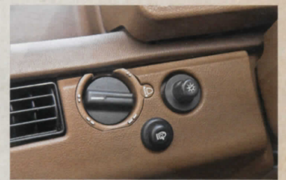
В зависимости от года выпуска фарочистители включались или совместно с «дворниками», или отдельной кнопкой (на фото)
