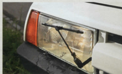
Щеточные фарочистители — в основном прерогатива экспортных машин. На каждой щетке есть форсунка подачи воды, система работает только при включенных фарах
