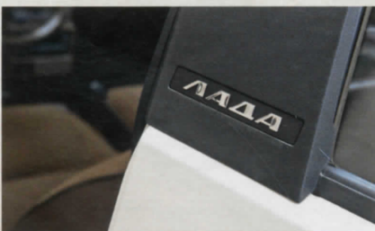
Декоративные накладки на средних стойках кузова скрывали клапаны вытяжной вентиляции салона
