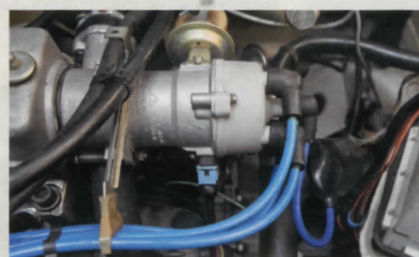
Бесконтактный распределитель зажигания с датчиком Холла
