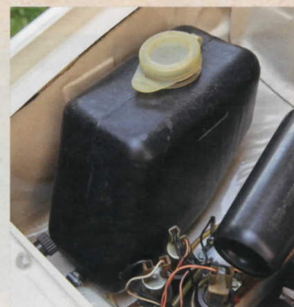
Ранний бачок омывателя стекол с системой клапанов и выносным насосом был черным, а позже его поменяли на белый полупрозрачный большего объема
