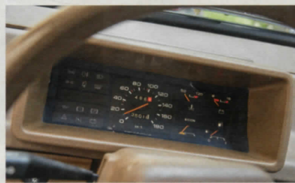
Комбинация приборов была компактной и информативной — у европейских аналогов редко встречались вольтметр и эконометр, который показывал разрежение в задрессельном пространстве
