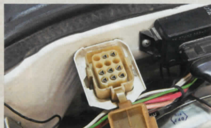
Колодка диагностики у карбюраторного двигателя! Согласно инструкции, «при помощи мотор-тестера и навесного датчика высокого напряжения можно определить уменьшение компрессии в цилиндрах, степень разряженности и состояние аккумулятора, исправность генератора, стартера и системы зажигания»
