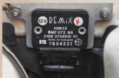
Импортный коммутатор бесконтактного зажигания (Венгрия) — мечта многих владельцев машин с ненадежными коммутаторами, построенными на отечественной элементной базе
