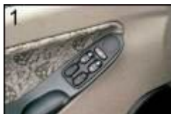
Клавиша блокировки замков дверей рядом с кнопками стеклоподъемников.
