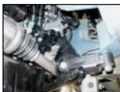
Привод правого колеса – сквозь кронштейн задней опоры силового агрегата.
