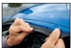
Под уплотнителем проема спрятаны точки крепления
