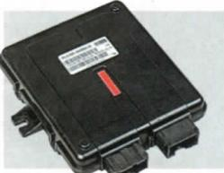
Модернизированные блоки управления кузовной электрикой в середине лета 2015 года встали на конвейер. Каталожный номер модуля привязан к комплектации машины. Индекс старого блока для Калины в исполнении Люкс – 21900-3840080-20, а обновленный имеет обозначение 60 на конце.
