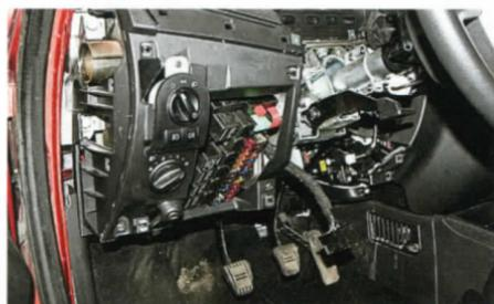
Согласно сервисной технологии при замене модуля кузовной электрики нужно снимать переднюю панель, поскольку доступ к нему крайне ограничен. Однако умельцы предлагаю более простой способ – в интернете есть подробные советы. Правда, этот вариант тоже требует времени и терпения. Я смог снять старый модуль за час, а вот сборка заняла два часа, и нервы были уже на пределе.
