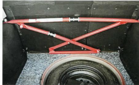
Задняя распорка подобной конструкции – пожалуй, единственное бесполезное решение из всего пакета усиления кузова. С ней можно рассчитывать лишь на эффект плацебо.
