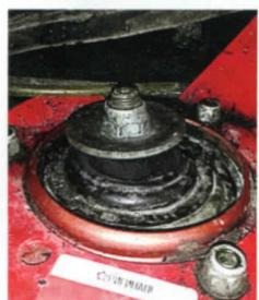
На суровых зимних спринтах оригинальная опора переднего амортизатора развалилась. Это легкое ранение. Были случаи, когда даже летом усиленные спортивные аналоги гнули стаканы кузова.
