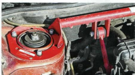
Чашка распорки и пластина на опоре амортизатора (ее ставят на заводе) хорошо усиливают стакан кузова, зажимая его в бутерброд. Эта конструкция надежно отработала летний сезон и даже зимний гоночный, когда кузову доставалось очень сильно из-за больших скоростей на неровных дорогах.
