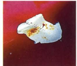
Такое ранение на капоте оставила ледышка, упавшая с крыши дома именно на ребро панели. Это случилось в январе 2019 года, а первые следы коррозии стали появляться лишь спустя полгода.
