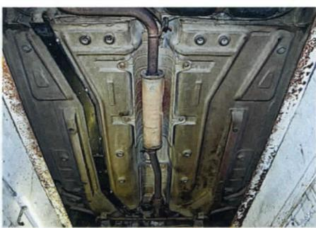
Состояние панелей днища и элементов силовой структуры очень хорошее. И это после частых и длительных простояов автомобиля на улице.
