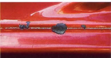
Уплотнительная резинка на водительской двери длительное время натирала дверной проем. Однако последствия проявились недавно – из-за механического воздействия стала откалываться краска.
