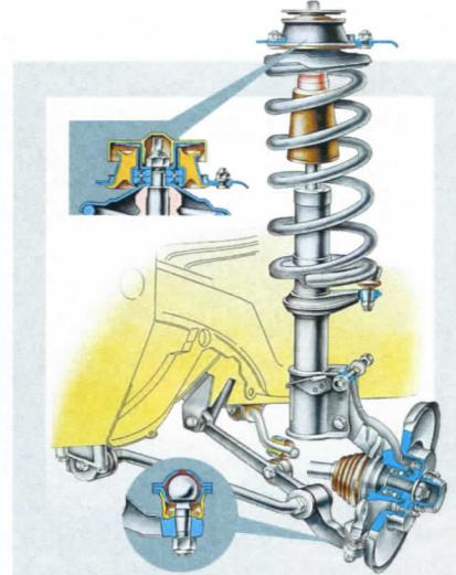
**ВАЗ-2108** был типичным переднеприводным европейским автомобилем своего класса (если не считать того, что от зарубежных лидеров этого сегмента он отстал практически на десятилетие): поперечно расположенный силовой агрегат сочетался с передней подвеской McPherson, задней упругой балкой с амортизаторными стойками, реечным рулевым управлением, дисковыми тормозами спереди и барабанными – сзади. Не секрет, что в доводке советского автомобиля активно участвовала фирма Porsche.
