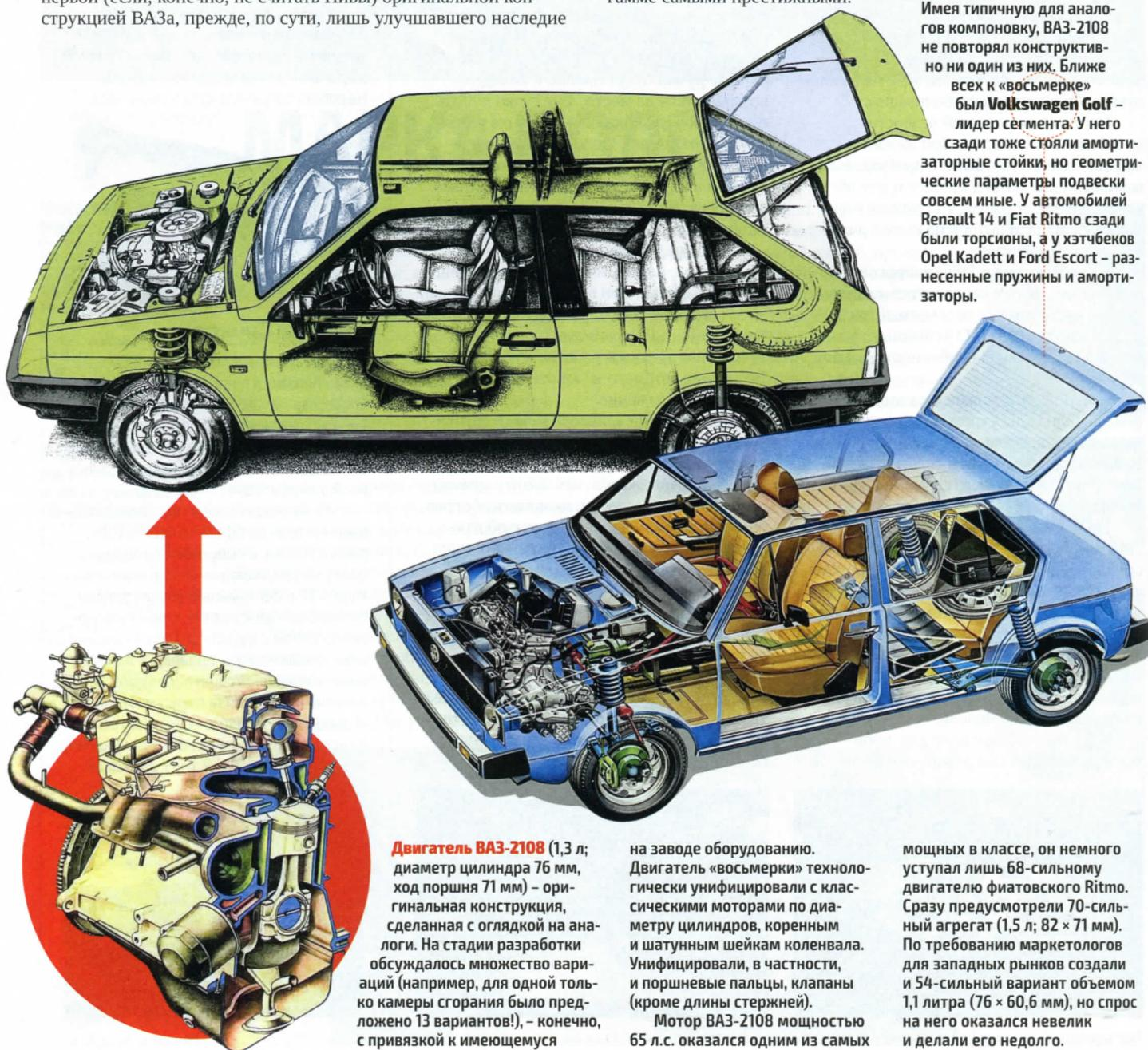
**Двигатель ВАЗ-2108** (1,3 л; диаметр цилиндра 76 мм, ход поршня 71 мм) – оригинальная конструкция, сделанная с оглядкой на аналоги. На стадии разработки обсуждалось множество вариантов (например, для одной только камеры сгорания было предложено 13 вариантов!), – конечно, с привязкой к имеющемуся
