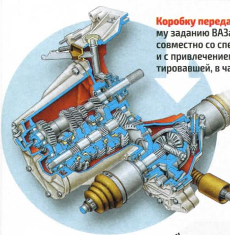
**Коробку передач** по техническому заданию ВАЗа разрабатывали совместно со специалистами Porsche и с привлечением компании ZF, проектировавшей, в частности, синхронизаторы. От идеи использовать детали коробки классических Жигулей отказались из-за жестких требований к максимально компактной, рассчитанной на поперечную установку коробке.
