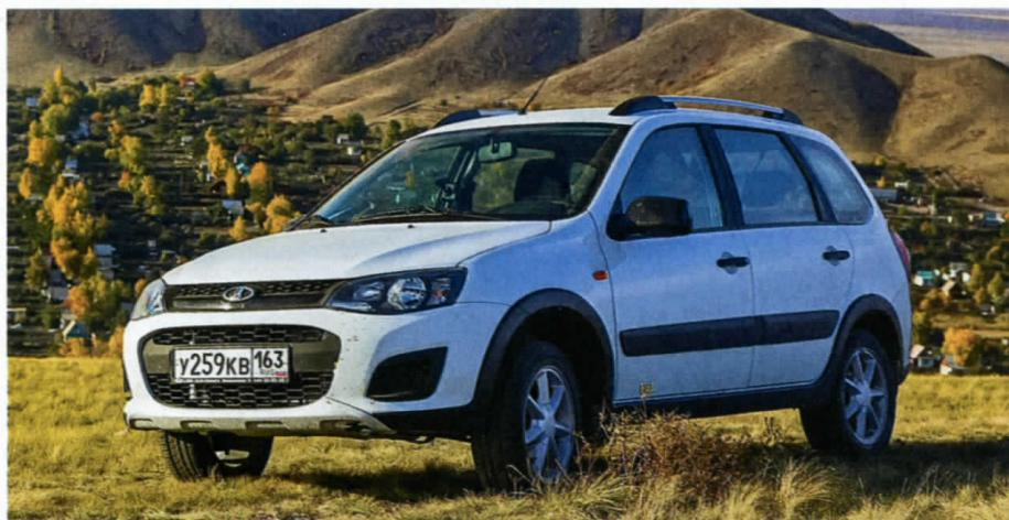
**i** Второе поколение от первого (2004–2013) отличается модернизированным кузовом и подвеской. Также освежили внешность, интерьер и оснащение. В частности, появилась мультимедийка с сенсорным дисплеем. Мотор 1.4 исчез, добавились обновленный двигатель 1.6 и автоматическая трансмиссия двух типов. Выпускали пятидверный хэтчбек и универсал, у которого есть версия Cross (плюс 23 мм просвета к базовым 185 мм).
