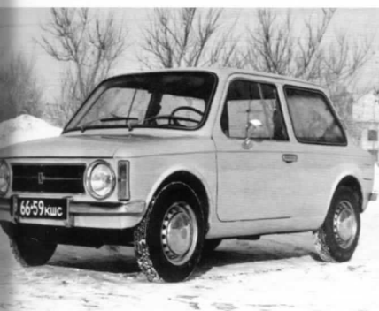
Первый опытный образец Э1101, созданный в январе 1972 года.
