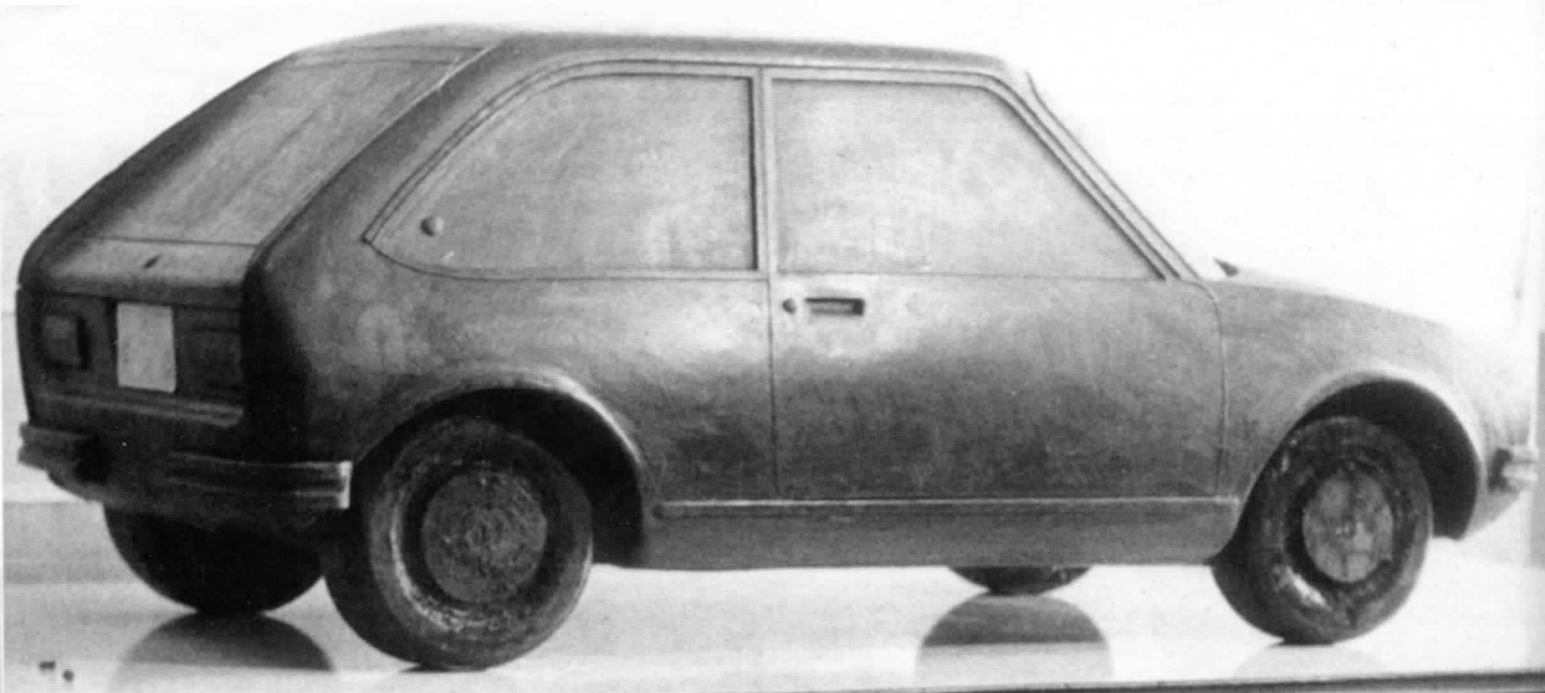
Один из первых масштабных пластилиновых макетов автомобиля ВАЗ-1101, предложенный дизайнером В.И. Пашко.
