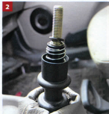
2 Узел частично разобран. Снята рукоятка с накладкой и гайкой. Для поддержания более стабильного контакта деталей я установил две шайбы – плоскую и пружинную.
