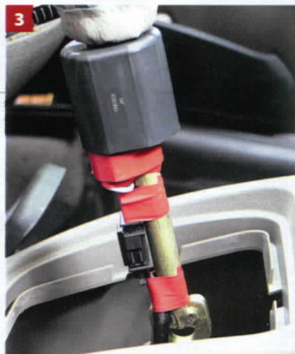
3 Оттянув сверху гильзу (это делал помощник), наматал на детали изоляционную ленту. Она заменила и пластиковый хомут, слабо державший электроразъем, и скомпенсировала лишние зазоры. Конечно, ее не должно быть слишком много, чтобы детали не клинило. Теперь рукоятка и гильза соединены плотно – шума стало меньше!
