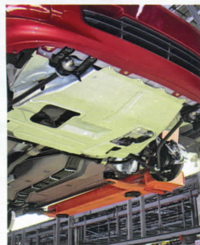
Для лучшей аэродинамики и защиты от грязи с августа 2006 года на «калинах» удлинили щитки моторного отсека. На экспортных автомобилях их дополнительно обклеивают шумоизолирующим материалом.
