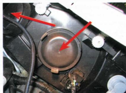
➒ Задние фонари для замены ламп надо снимать, а для этого одних рук недостаточно – нужны ключ-головка «на 8» и сноровка, чтобы не обронить гайки и шайбы в полость крыла.
