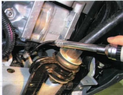
➐ Топливный фильтр стоит между баком и правым порогом кузова. Перед тем как отсоединять наконечники, сбросьте давление, например, через золотник на топливной рампе двигателя.
