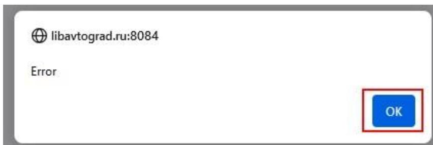
Рисунок 10. Диалоговое окно при ручной книговыдаче, реагирует на отсутствие подключения считывателя RFID
