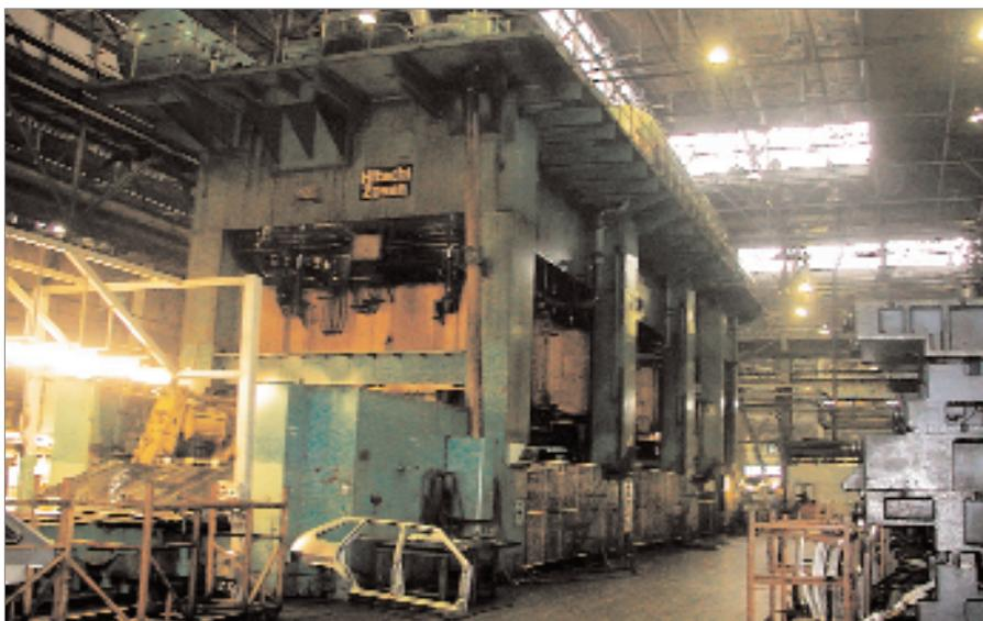
Многопозиционная линия «Хитачи» для штамповки крупногабаритных деталей кузова
