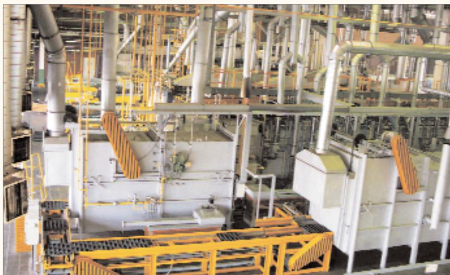
Современная печь для нитроцементации деталей с предварительным оксидированием, созданная по теории «Механизма Тихонов-Кристал»
