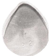
Распредвал из чугуна с вермикулярным графитом и кулачок с отбеленным слоем
