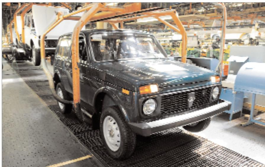
Конвейер сборки «Нивы»
