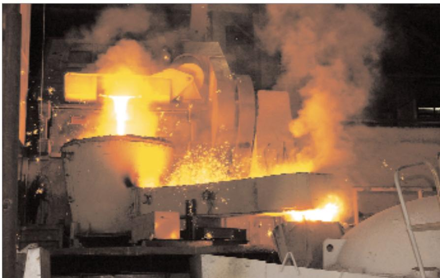
Индукционная печь для плавки чугуна
