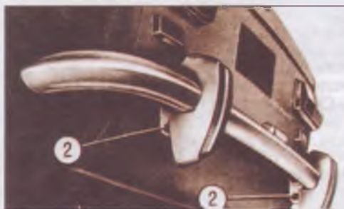
▲ Отверстие (3) для заводной рукоятки — требование российских условий эксплуатации. Под бамперами «Жигулей» появились буксирные проушины (1, 2). ▼
