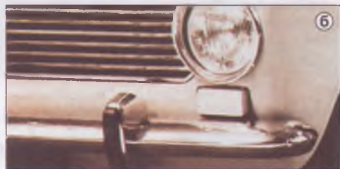
ФИАТ-124 имел на бамперах небольшие резиновые упоры (а), на «Жигулях» появились «клькы», защищающие машину от «подныривания» под препятствие (б).
